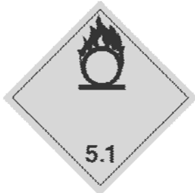
(5.1 sz. bárca) A jelkép (kör feletti láng): fekete; a háttér: sárga; '5.1' számjegyek az alsó sarokban,
