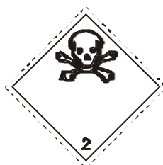
(2.3 sz. bárca) Mérgező gázok A jelkép (halálfej) fekete; a háttér: fehér; '2' számjegy az alsó sarokban
