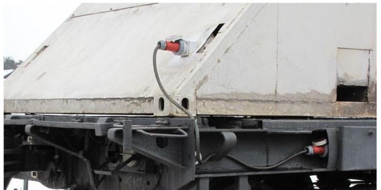
Рисунок 69 – Примеры подключения АДГУ к сети электроснабжения платформы
