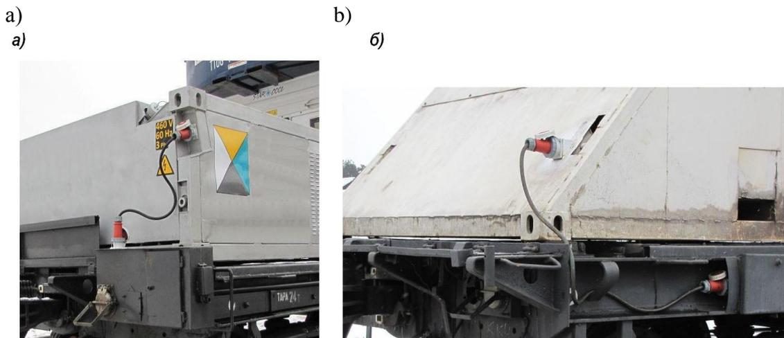
69. ábra – Példák az ADGU pórekocsi villamosenergia-hálózatába történő bekötésére, a – az ADGU „Progresszor-01” bekötése; b — az ADGU RKV-15 bekötése
