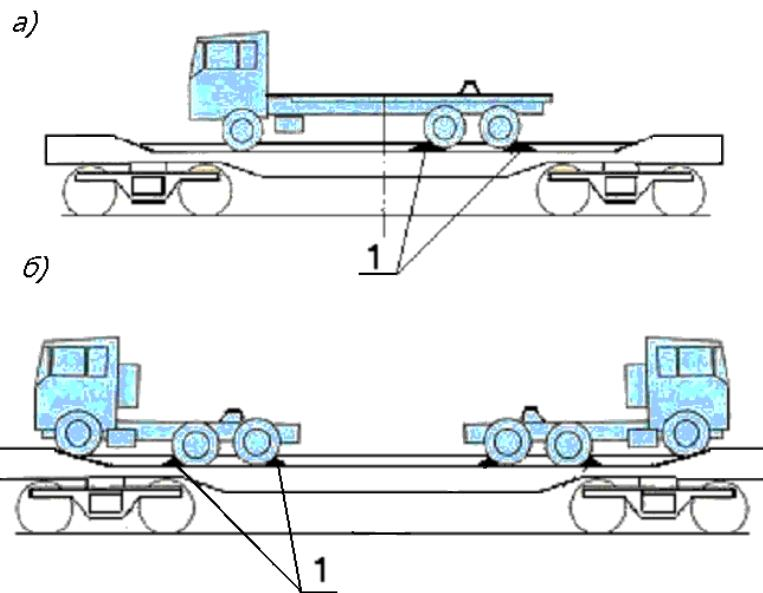
Рисунок 16 – Размещение и крепление тягачей
