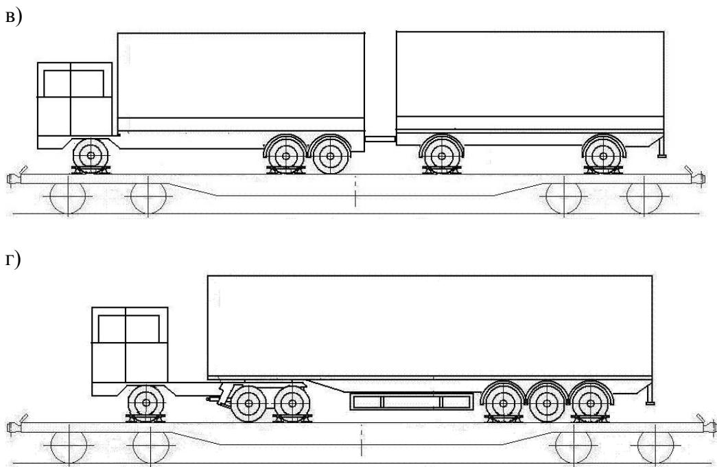
Рисунок 6 – Размещение и крепление автопоездов, автомобилей
