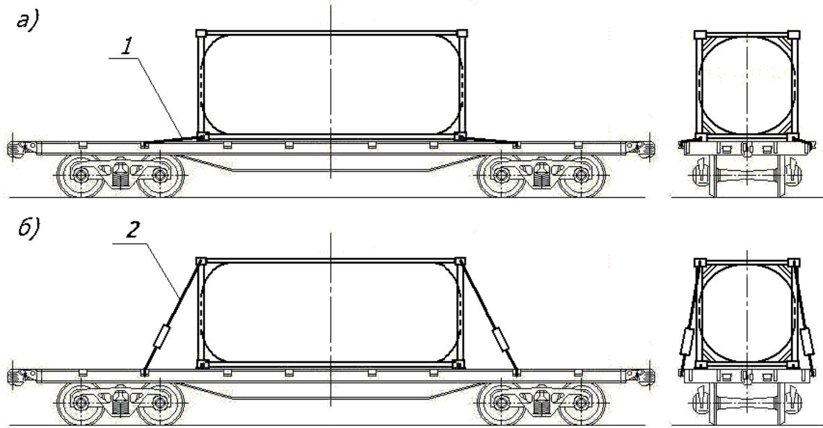
Рисунок 26-7 – Дополнительное крепление контейнера-цистерны на платформе базой 9720
