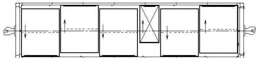
Рисунок 2 – Размещение контейнеров в полувагоне и контейнеровозе с внутренней длиной кузова до 12228 мм
