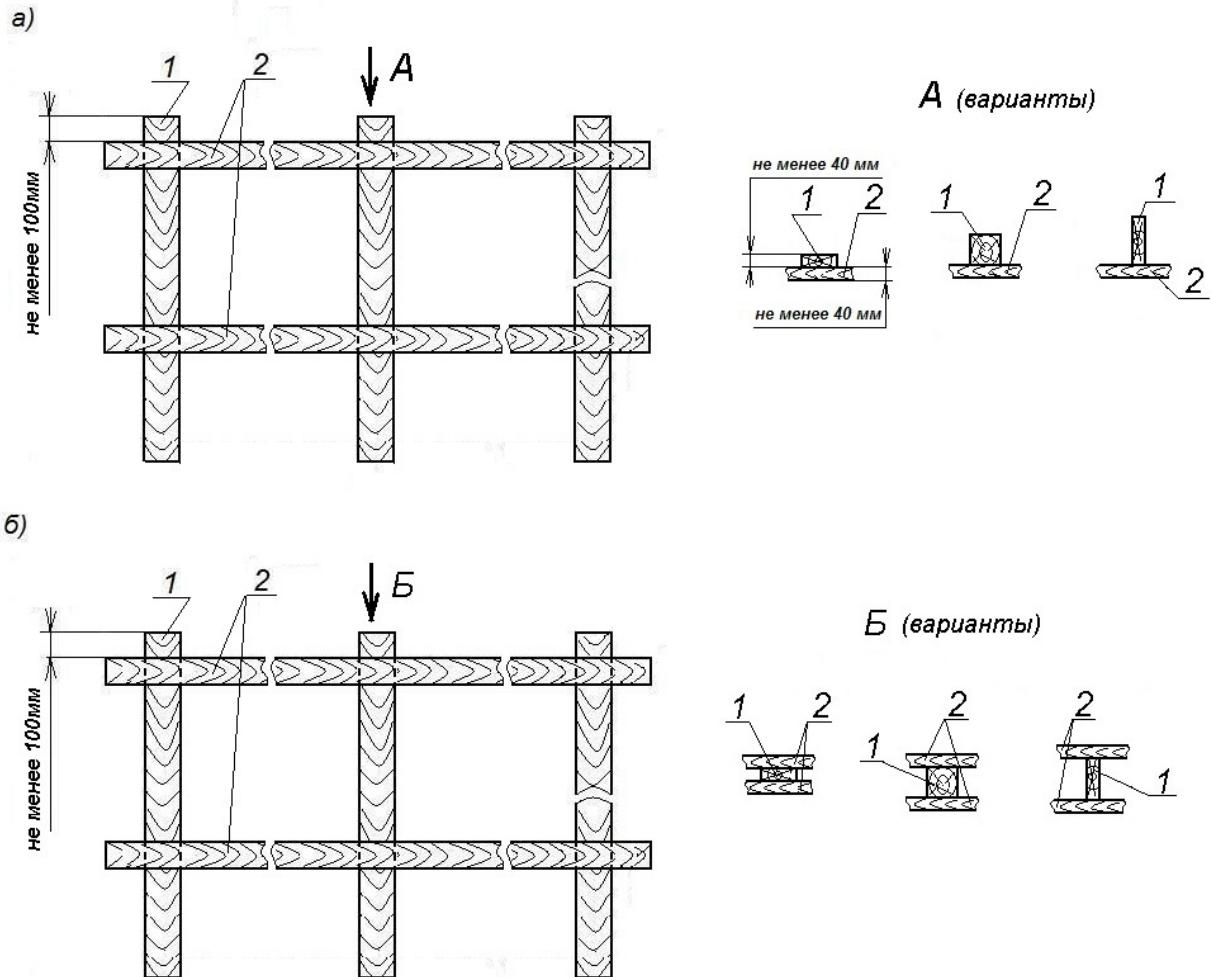
Рисунок 7 – Варианты изготовления распорного щита
