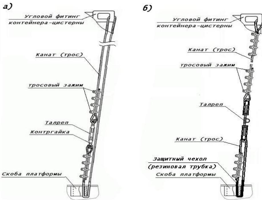
Рисунок 26-11 – Примеры установки тросовой растяжки крепления контейнера-цистерны:
