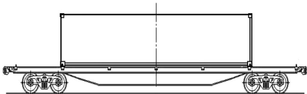
**15. ábra** - Egy darab 40 láb hosszúságú konténer elhelyezése a 13900 mm, 14400 mm és 14720 mm forgócsap távolságú nagykonténer-szállító pőrekocsiban
