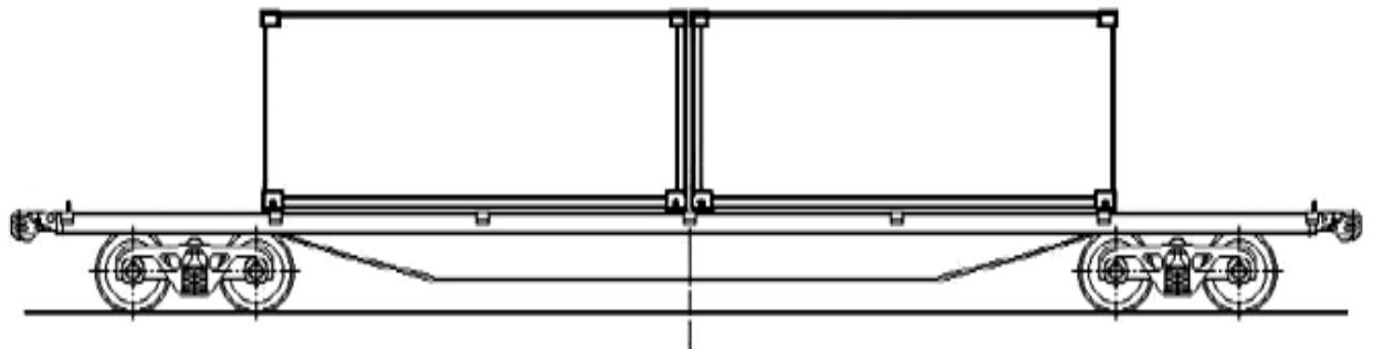
**11. ábra** - Kettő darab 20 láb hosszúságú konténer elhelyezése a 13900 mm, 14400 mm és 14720 mm forgócsap távolságú nagykonténer-szállító pőrekocsik középső részén
