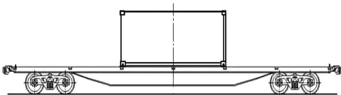
**13. ábra** - Egy darab 20 láb hosszúságú konténer elhelyezése a 13900 mm, 14400 mm és 14720 mm forgócsap távolságú nagykonténer-szállító pőrekocsiban
