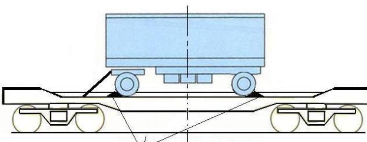
Рисунок 15 – Размещение и крепление прицепа
