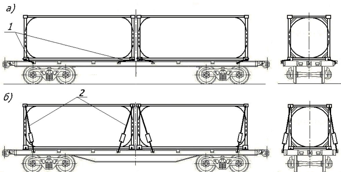
Рисунок 26-6 – Дополнительное крепление контейнеров-цистерн
