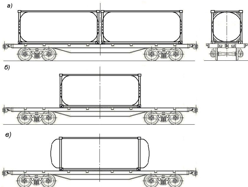
**23. ábra** - A 20 láb hosszúságú tankkonténerek elhelyezése a nagykonténer-szállító, valamint általános rendeltetésű, konténerrögzítő tüskékkel külön ellátott, 9720 mm forgócsap távolságú pőrekocsikban
