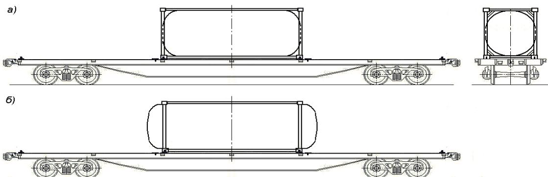
**26. ábra** - A 20 láb hosszúságú tankkonténer elhelyezése a 13900 mm, 14400 mm és 14720 mm forgócsap távolságú nagykonténer-szállító pőrekocsiban
