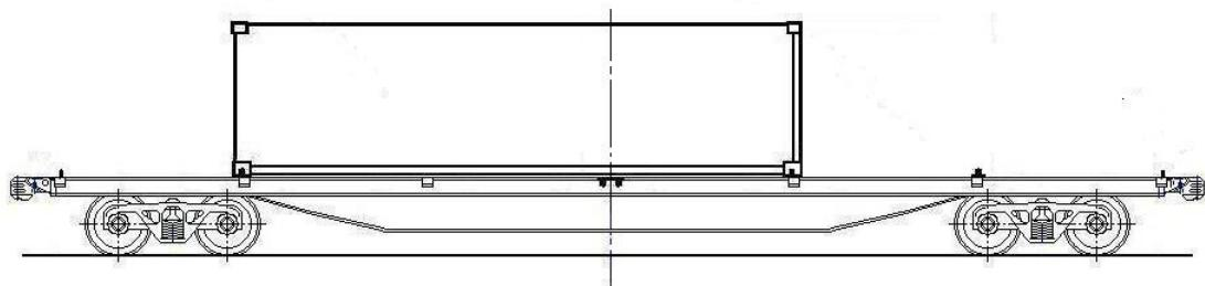
**13-1. ábra** – A 30 láb hosszúságú konténer elhelyezése a 13900 mm, 14400 mm, 14720 mm forgócsap távolságú, nagykonténerek szállítására rendelt pőrekocsikon
