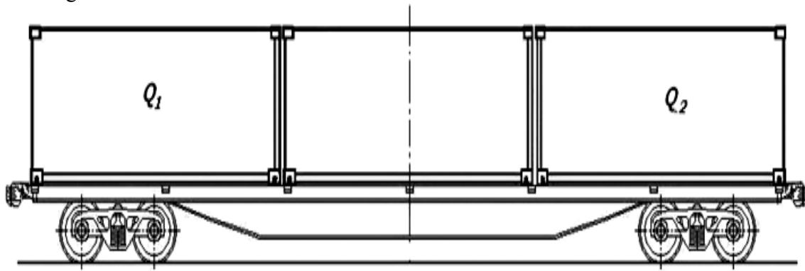
**10. ábra** - Három darab 20 láb hosszúságú konténer elhelyezése a 13900 mm, 14400 mm és 14720 mm forgócsap távolságú nagykonténer-szállító pőrekocsiban
