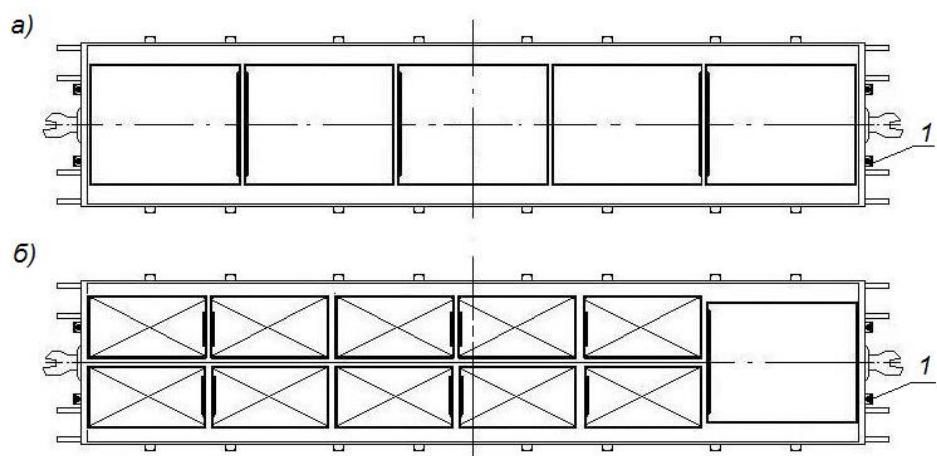
Рисунок 1 – Размещение контейнеров на универсальной платформе с внутренней длиной кузова 13300 мм
