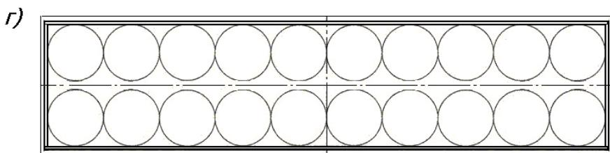
Рисунок 29 – Принципиальная схема размещения мягких контейнеров
