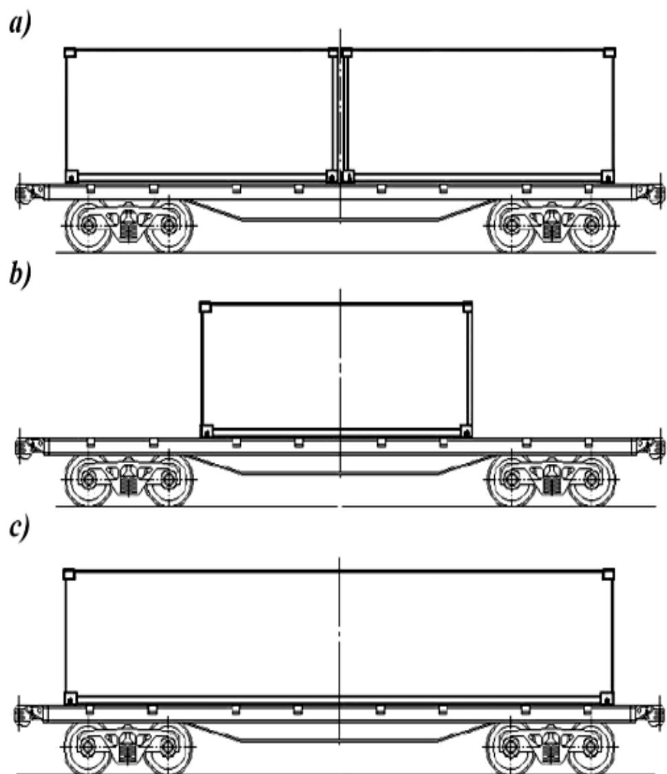
**9. ábra** - A konténerek elrendezése nagykonténer-szállító, valamint általános rendeltetésű, konténerrögzítő tüskékkel külön ellátott, 9720 mm forgócsap távolságú pőrekocsikon
