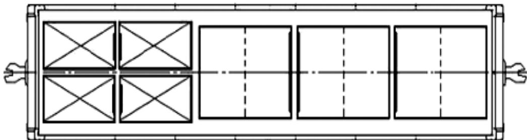
**5. ábra** - A konténerek elrendezése konténerszállító kocsiban, kívülről a sarokrakoncákhoz erősített gerendakapocs vagy gerenda homlokbiztosítással
