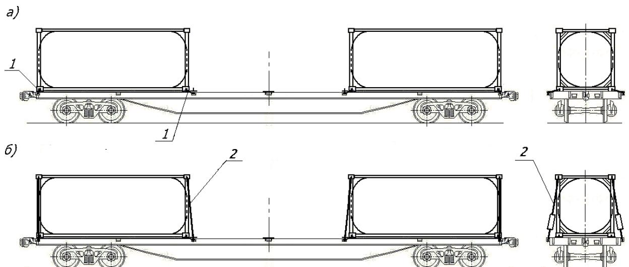
26-9. ábra – Tankkonténerek kiegészítő lekötése a pőrekocsin nagykonténerek esetén:
