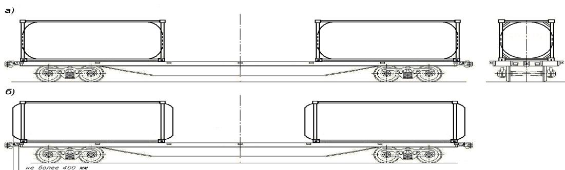
**25. ábra** - Kettő darab 20 láb hosszúságú tankkonténer elhelyezése a 13900 mm, 14400 mm és 14720 mm forgócsap távolságú nagykonténer-szállító pőrekocsiban
