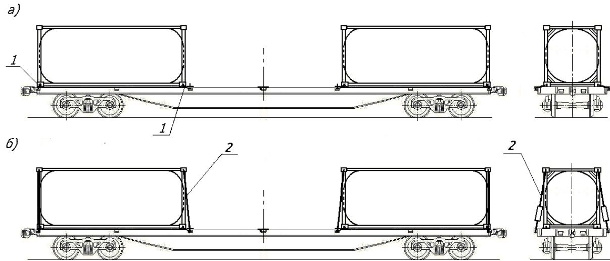
Рисунок 26-9 – Дополнительное крепление контейнеров-цистерн на платформе для крупнотоннажных контейнеров:
