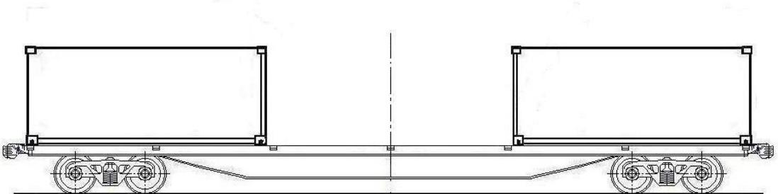
Рисунок 12 – Размещение двух контейнеров длиной 20 футов по торцам платформы для крупнотоннажных контейнеров базой 13900 мм, 14400 мм, 14720 мм
