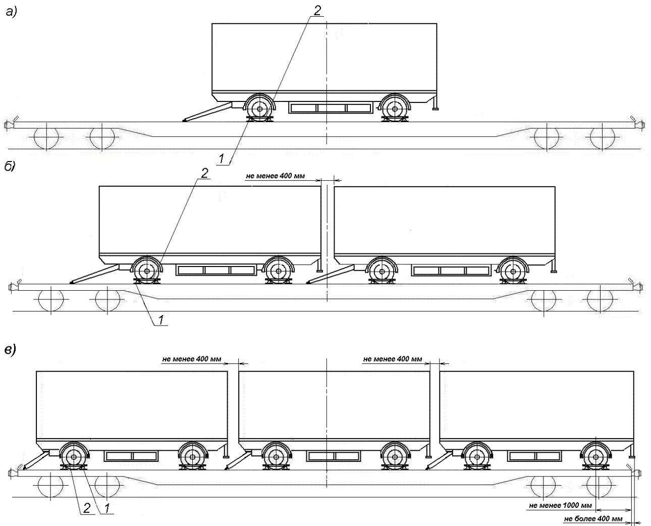
Рисунок 8 – Размещение и крепление прицепов
