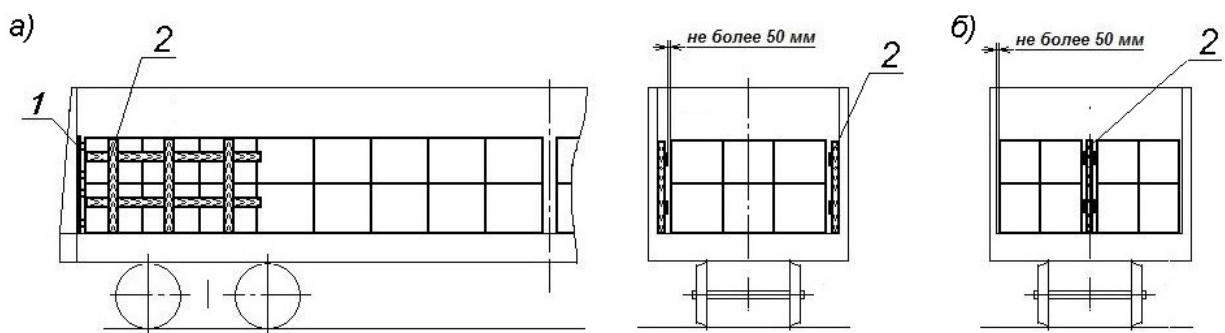
Рисунок 6 – Примеры крепления пакетов в поперечном направлении
