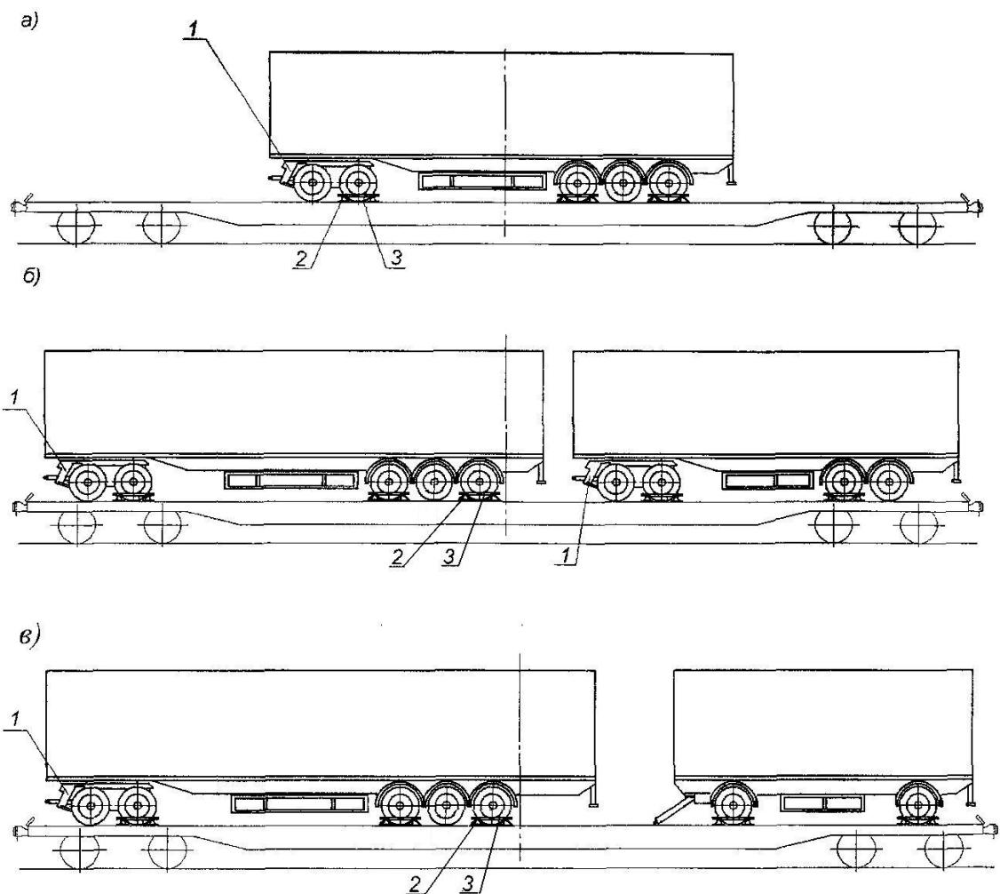
Рисунок 9 – Размещение и крепление полуприцепов и прицепов
