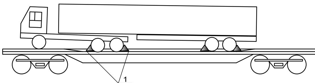
Рисунок 11 – Размещение и крепление автопоезда (тягач-полуприцеп)
