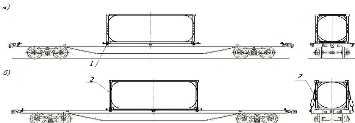
Рисунок 26-10 – Дополнительное крепление контейнера-цистерны на платформе для крупнотоннажных контейнеров:
