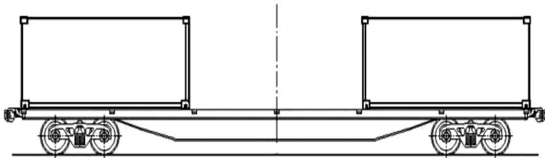
**12. ábra** - Kettő darab 20 láb hosszúságú konténer elhelyezése a 13900 mm, 14400 mm és 14720 mm forgócsap távolságú nagykonténer-szállító pőrekocsik homlokárénél
