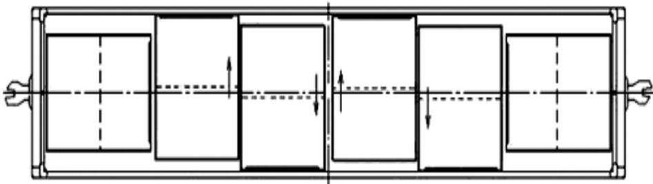
**8. ábra** - A konténerek elrendezése 14190 mm belső szekrényhosszúságú konténerszállító kocsiban
