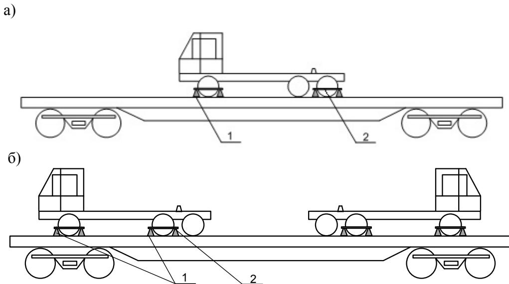
Рисунок 10 – Размещение и крепление тягачей
