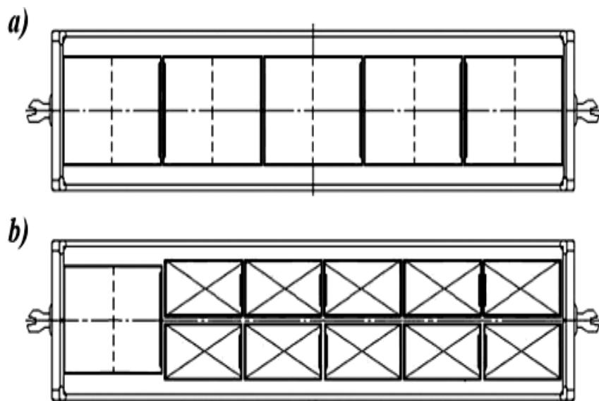
**7. ábra** - A konténerek elrendezése 13430 mm belső szekrényhosszúságú konténerszállító kocsiban
