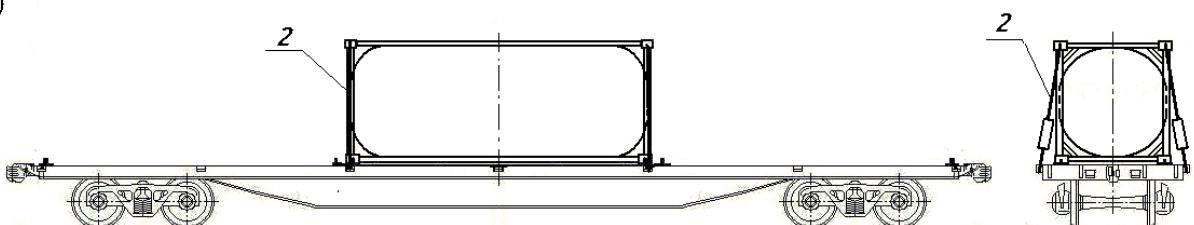
26-10. ábra – Tankkonténerek kiegészítő lekötése a pőrekocsin nagykonténerek esetén
