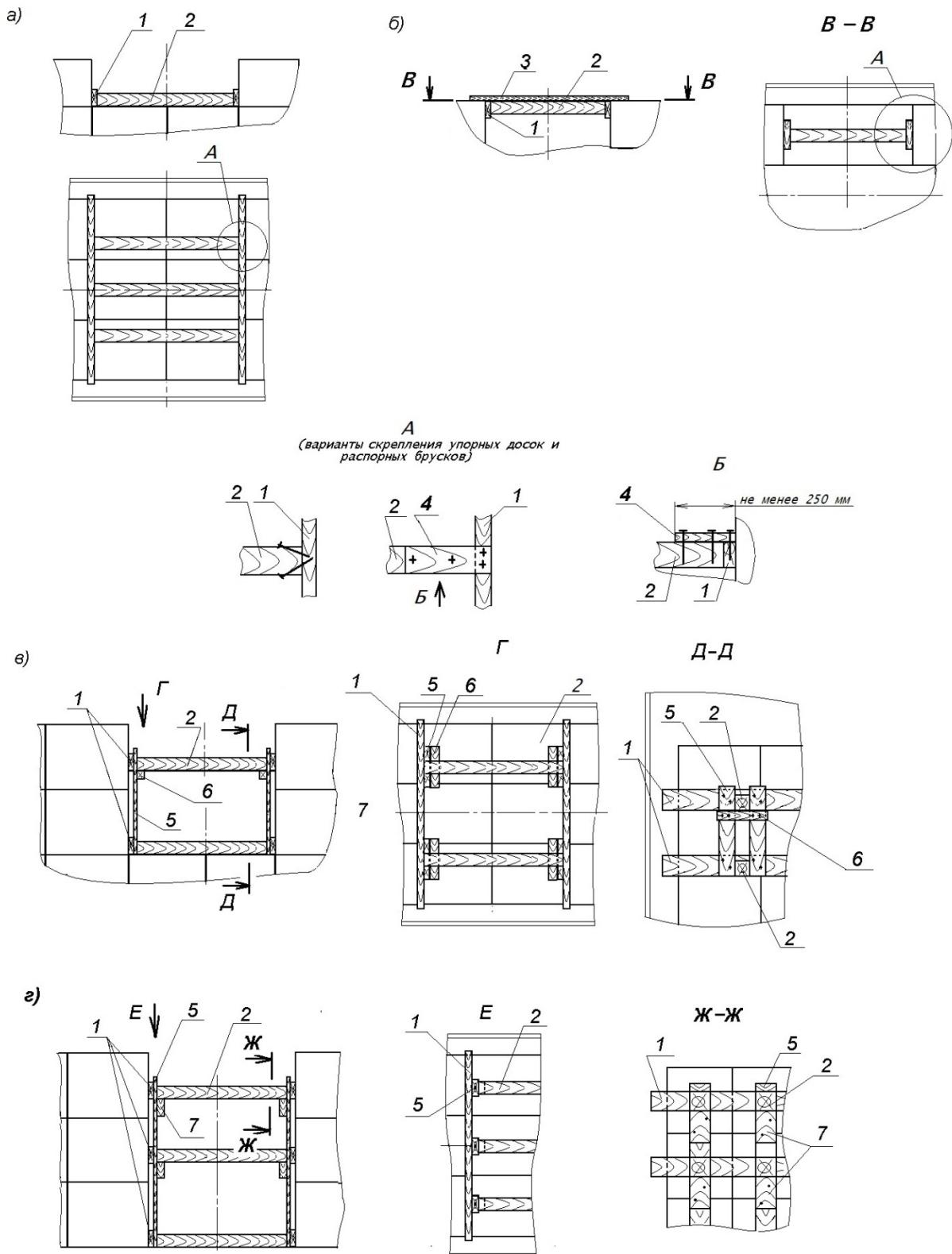
Рисунок 5 – Распорная рама, накладка-распорка, распорная конструкция
