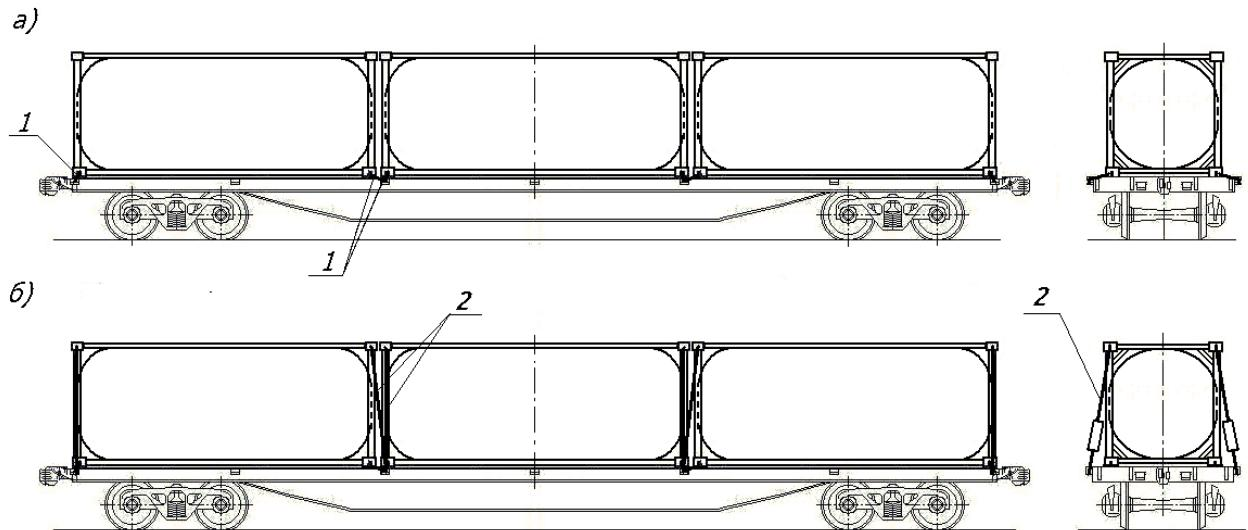
26-8. ábra – Tankkonténerek kiegészítő lekötése a pőrekocsin nagykonténerek esetén:
