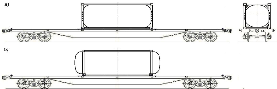
Рисунок 26 – Размещение контейнера-цистерны длиной 20 футов на платформе для крупнотоннажных контейнеров базой 13900 мм, 14400 мм, 14720 мм
