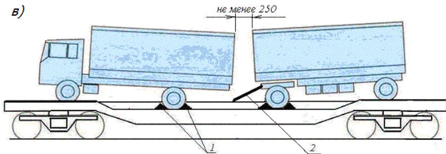
Рисунок 13 – Размещение и крепление автопоезда (автомобиль-прицеп)
