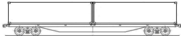
**13-2. ábra** – Kettő darab 30 láb hosszúságú konténer elhelyezése a 13900 mm, 14400 mm, 14720 mm forgócsap távolságú nagykonténer-szállító pőrekocsikon
