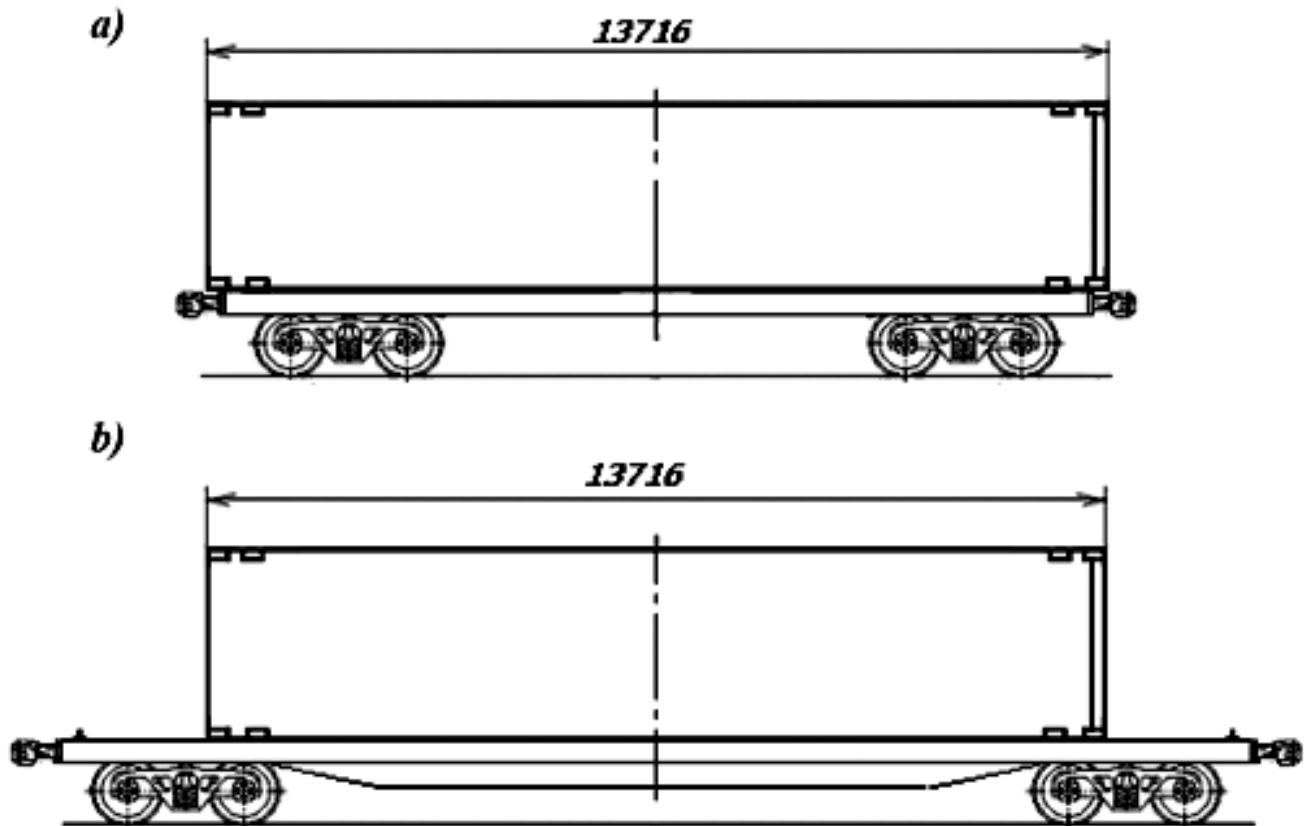
**16. ábra** - A 45 láb hosszúságú konténer elhelyezése a nagykonténer szállító pőrekocsiban:
