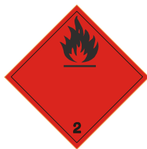
(2.1 sz. bárca) Gyúlékony gázok A jelkép (láng): fekete vagy fehér (kivéve, ha az 5.2.2.2.1.6 c) pont szerinti); a háttér: vörös; '2' számjegy az alsó sarokban
