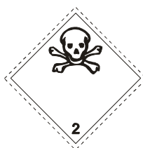
(2.3 sz. bárca) Mérgező gázok A jelkép (halálfej): fekete; a háttér: fehér; '2' számjegy az alsó sarokban
